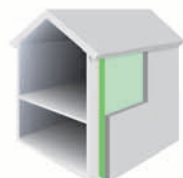
Теплоизоляция в двойной стене
